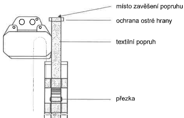
Obr. 11: Stacionární kladkostroj s vakem zavěšeným. (Místo pro zavěšení popruhu musí být zajištěno uživatelem.)
